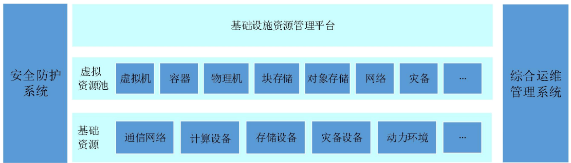
图 1 指挥中心信息基础设施系统组成
